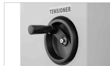
Regolazione della tensione del feltro
